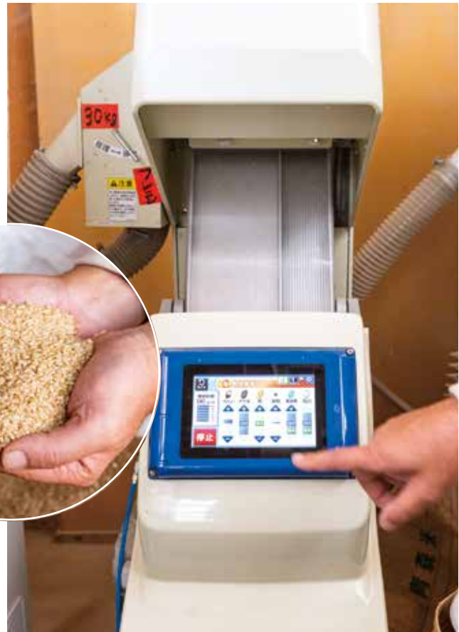
斑点米をはじめとした着色粒を飛ばす選別機
