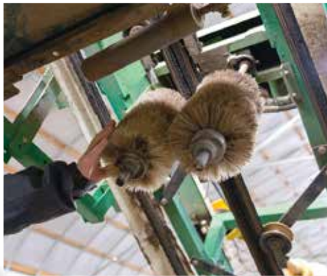
こぼり用ハーベスタはブラシを付けたことで土落としの作業を簡略化。
