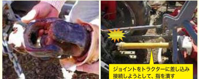
ジョイントをトラクターに差し込み接続しようとして、指を潰す
