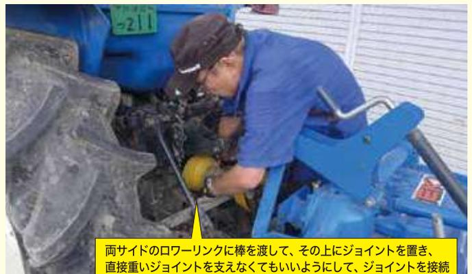
両サイドのローリンクに棒を渡して、その上にジョイントを置き、直接重いジョイントを支えなくてもいいようにして、ジョイントを接続
