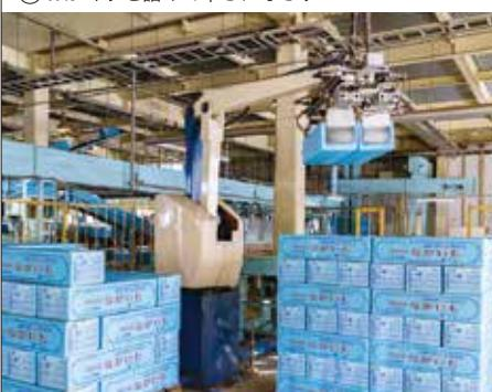
⑦ロボットが自動判別してパレットに積み上げる
